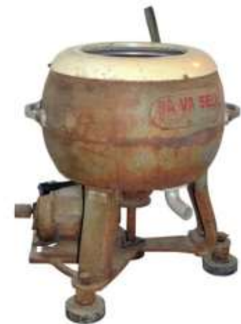
Essoreuse centrifuge Ça va seul, fonctionnant à l'électricité. Son tambour est vertical.
