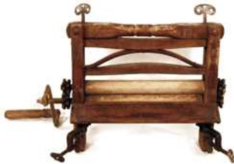
Essoreuse manuelle que l'on fixe sur un récipient ou une machine à laver au moyen d'un système de serre-joints. La pression exercée sur le linge se règle à l'aide des deux vis papillon, situées de part et d'autre du cadre en bois et surmontant un cintre métallique.
