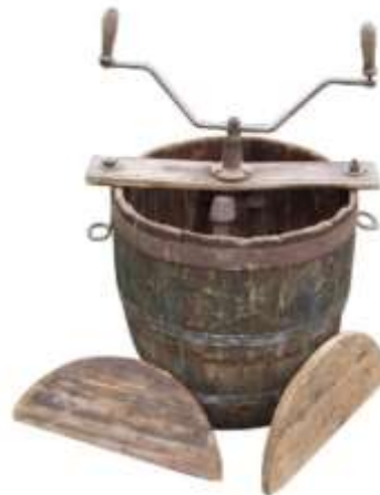
Machine à laver « va-et-vient ». Elle est constituée d'un tonneau dans lequel les trois pales sont mues de gauche à droite, par deux personnes, à l'aide d'un volant-manivelle situé sur le dessus du récipient.
